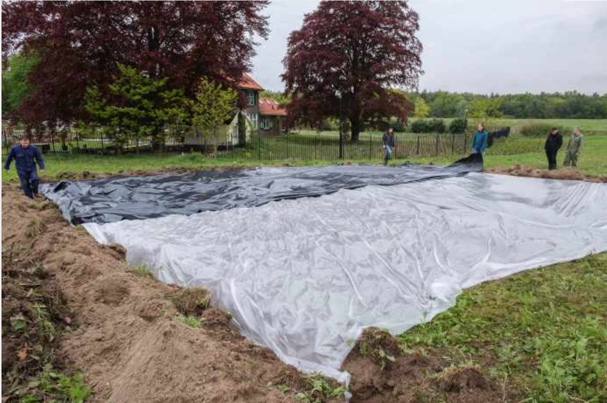
Figuur 8. Afdekken van het proefvlak met eerst een luchtdicht folie en vervolgens een landbouwfolie.
